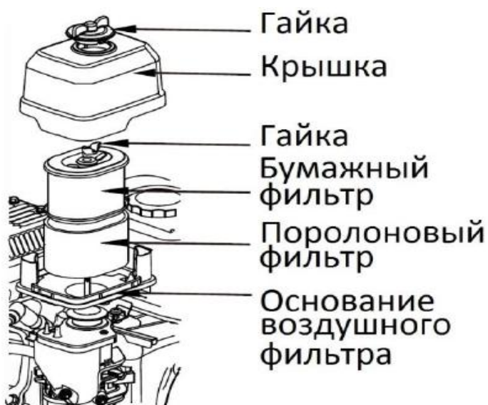
Рис. 7 – Устройство воздушного фильтра
