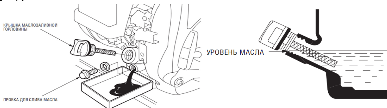
Рис.16 – Замена моторного масла
